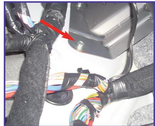
**NOTE :** Le connessioni dovranno essere eseguite con saldatura del cavo o crimpatura, e isolate tramite guaina termoretraibile o nastro isolante.
