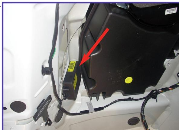
**SEGNALATORE ACUSTICO** : Fissare il segnalatore acustico (buzzer) sul fianco baule lato guida. Per il fissaggio, utilizzare il velcro in dotazione.
