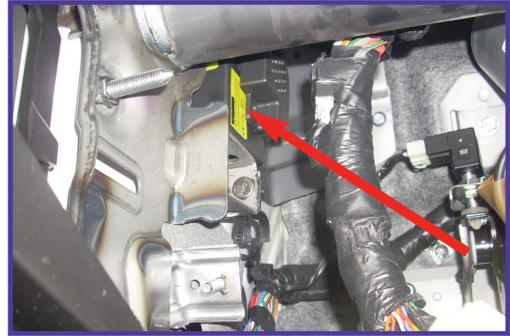
**SEGNALATORE ACUSTICO:** Posizionare il buzzer all'interno dell'abitacolo direttamente sulla centralina parking posizionata nel capitolo precedente. Per il fissaggio, utilizzare il velcro in dotazione.
